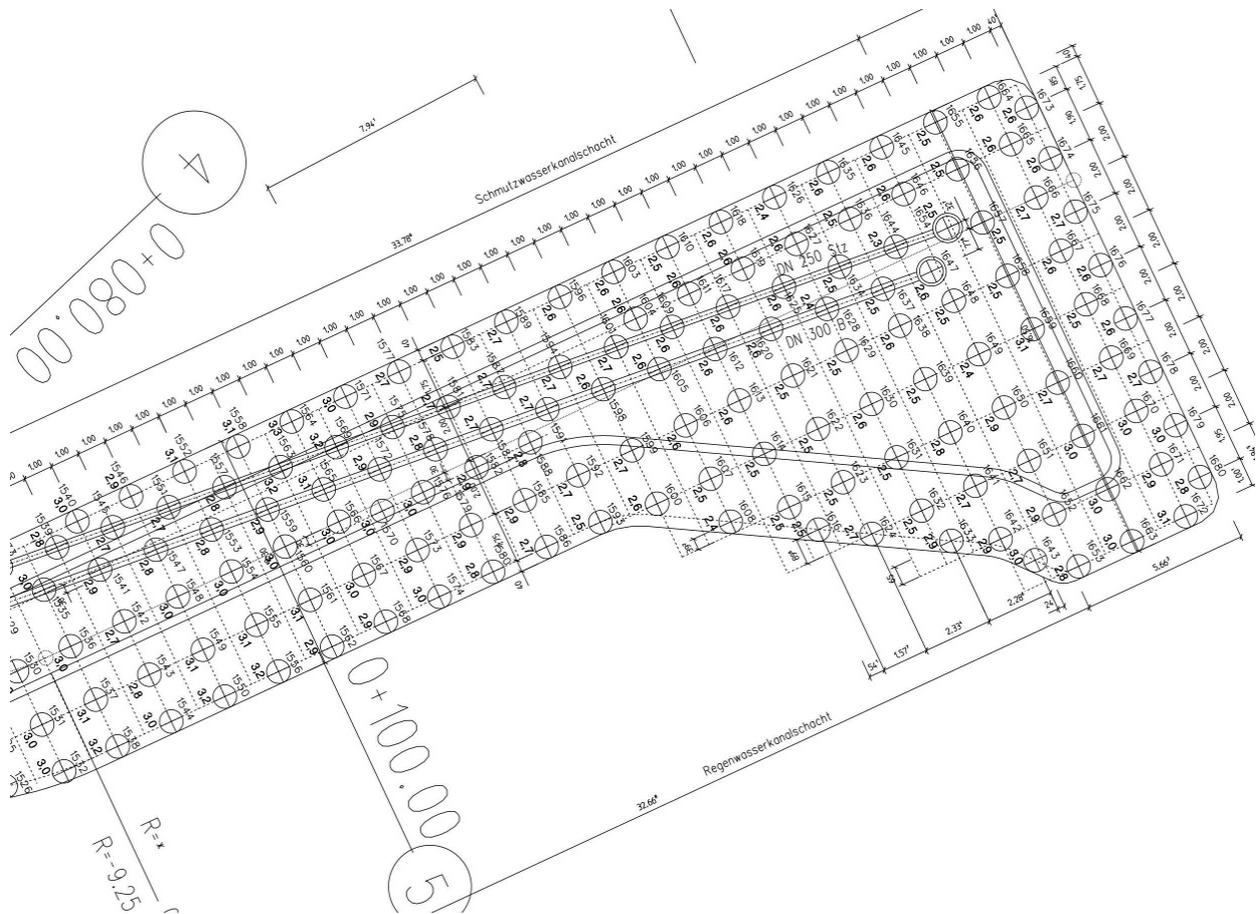
Bild 10.1: Rüttelstopfverdichtung „Nördl. Victor-Gollancz-Straße“ in Jülich (Auszug aus Unterlage 2.13)
