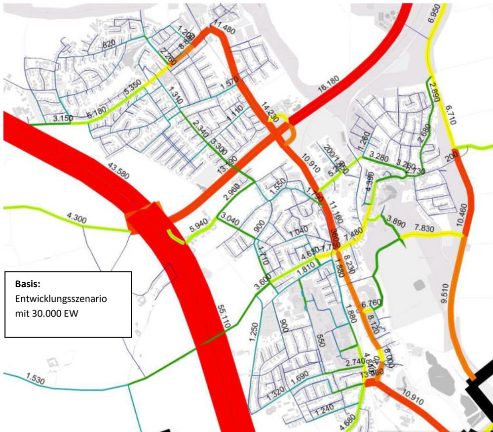
Abb. 3.2-7 Kfz-Belastungen an einem Werktag für die Nullprognose 2030 im Querschnitt für das Entwicklungsszenario (30.000 EW)
