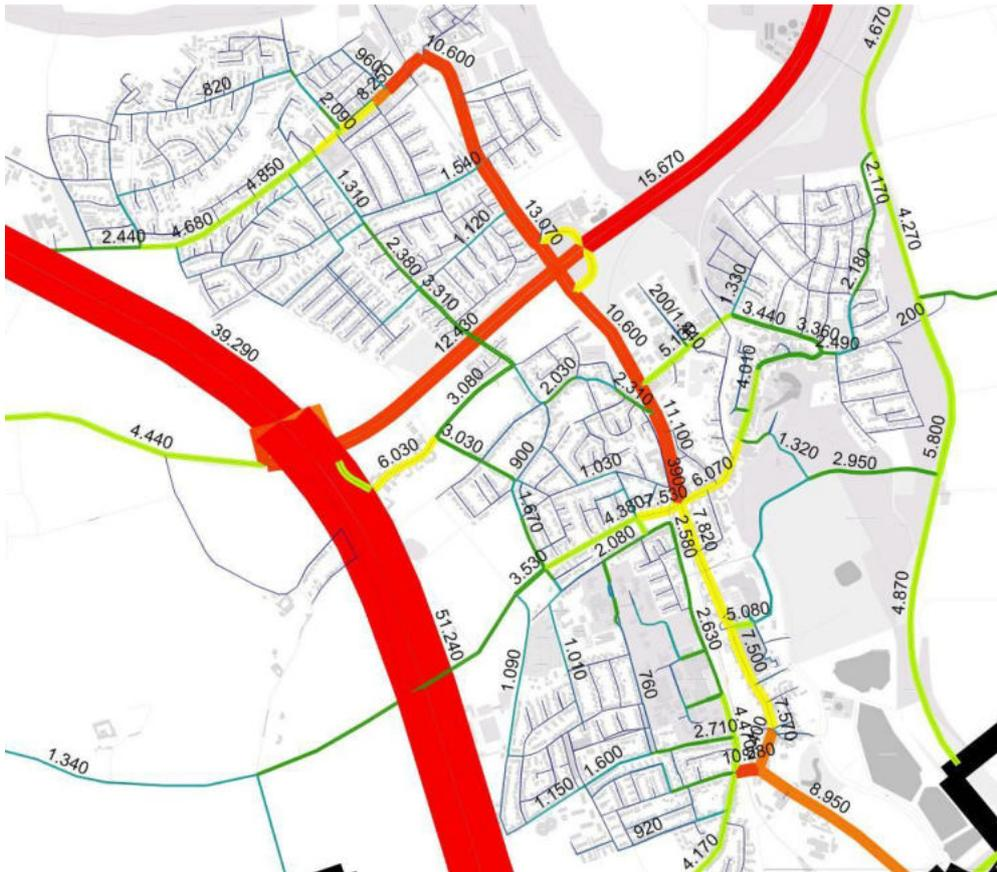
Abb. 3.2-4 Kfz-Belastungen an einem Werktag für den heutigen Zustand (2015) im Querschnitt
