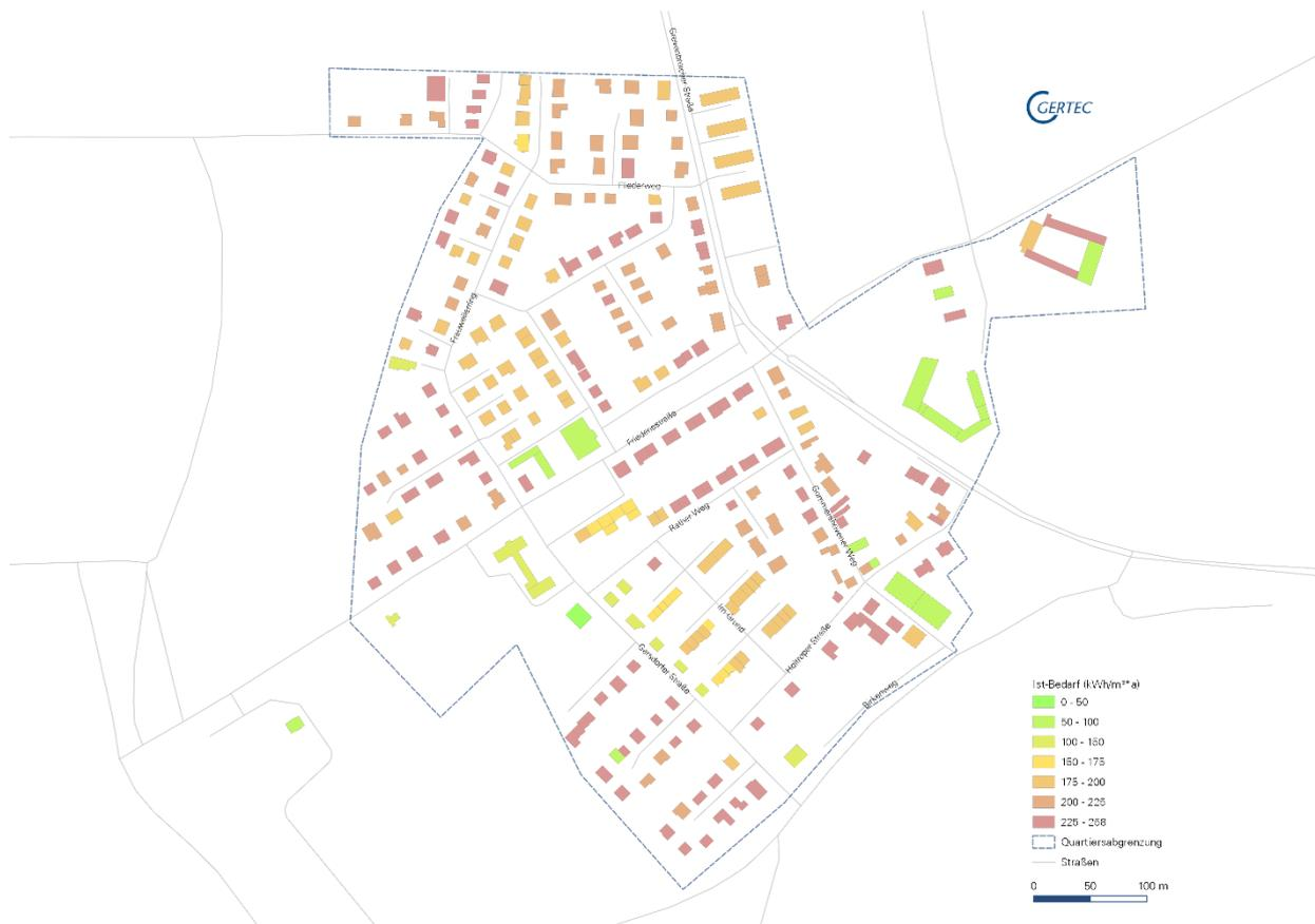
Abbildung 10 Kennwerte der eingesetzten Heizenergie pro  $m^2$  ( Quelle: eigene Darstellung Gertec, IWU)
