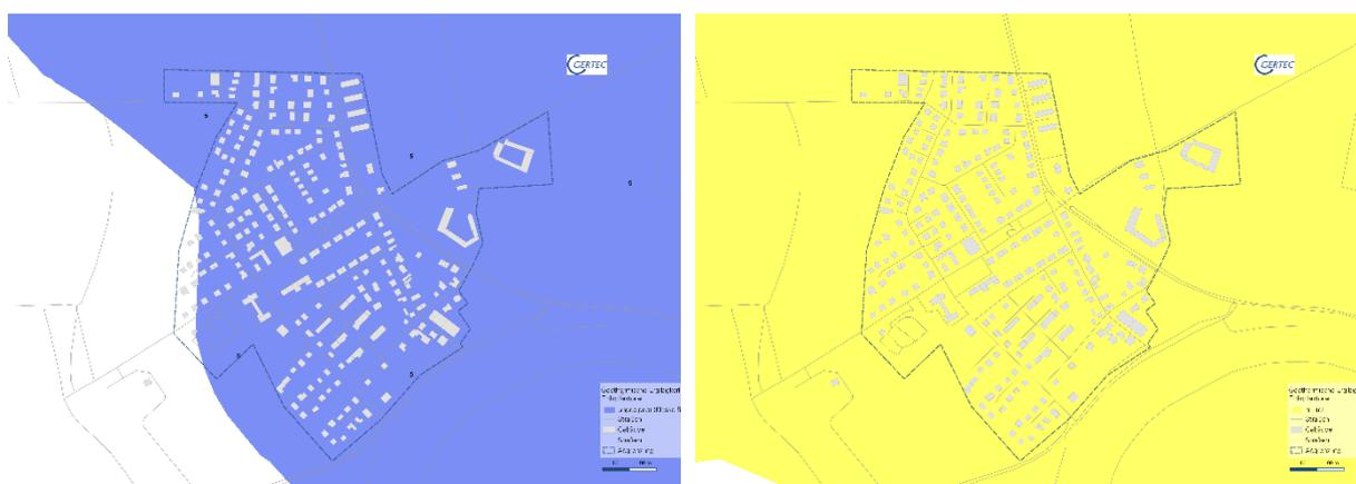
Abbildung 25 Darstellung Geothermiepotezial (links Erdsonden 80 m Sondentiefe, rechts Erdkollektoren) (Quelle: eigene Darstellung Gertec, LANUV NRW)
